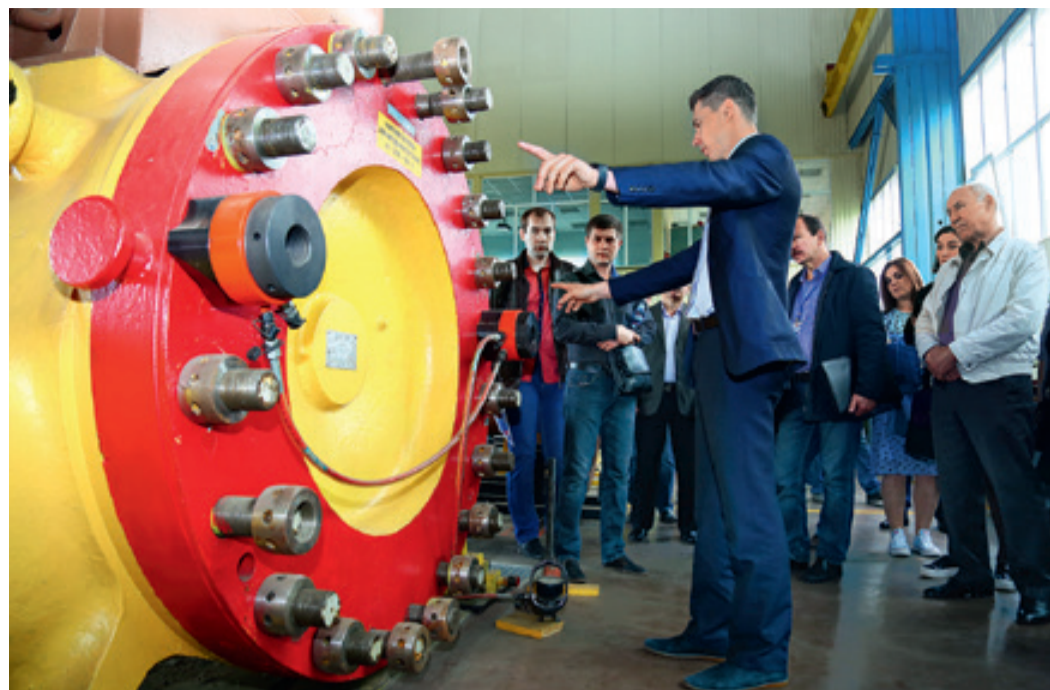
Дмитрий Попков рассказывает о современной методике разборки центробежного нагнетателя газа с помощью гидравлического инструмента
